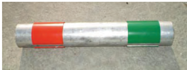
Участок жесткой ошиновки с маркировочными кольцами
