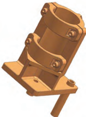
Узел соединения оборудование-шина №1
